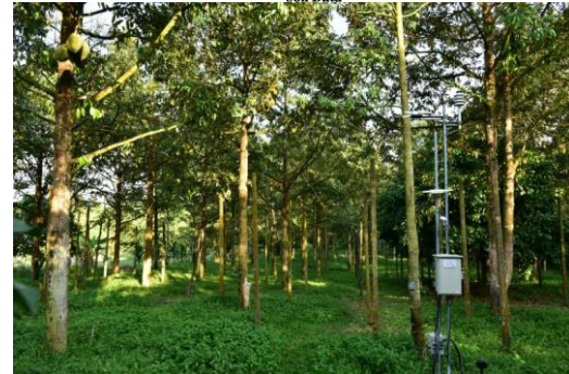
ภาพ การติดตามสภาพภูมิอากาศ สถานีตรวจอากาศ IoT ในสวนทุเรียนในจันทบุรี ประเทศไทย
