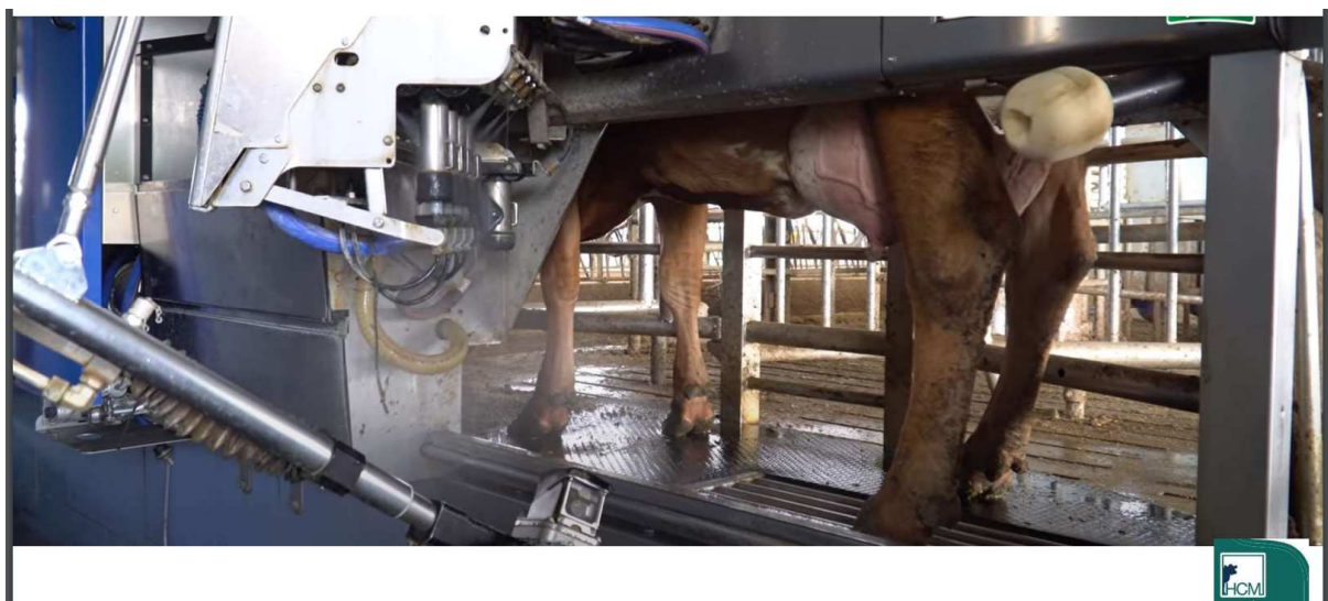
ภาพที่ 11 มีการนำเครื่องจักร และอุปกรณ์ IOT เข้ามาใช้ในฟาร์มเพื่อประเมินการให้นมและนำไปวิเคราะห์เพื่อหาสภาพที่เหมาะสมที่ทำให้วัวให้ปริมาณน้ำนมได้เต็มที่ และมีคุณภาพสูง
