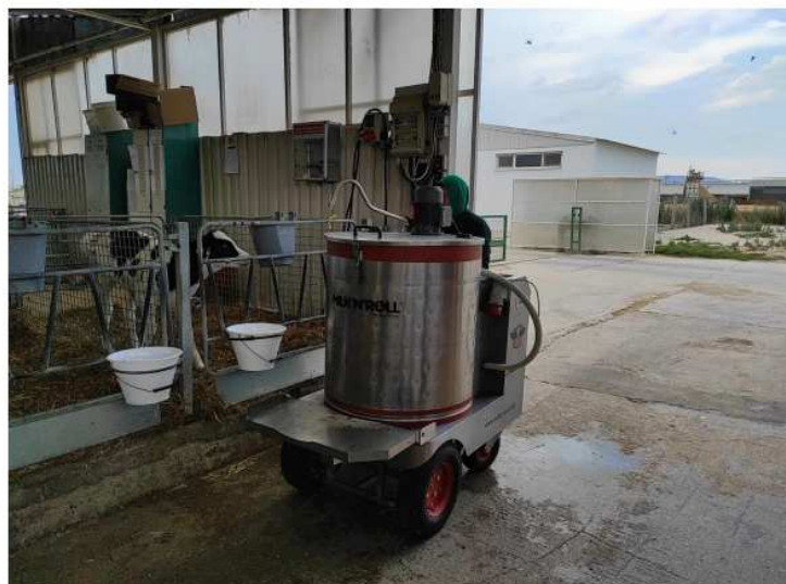
ภาพที่ 9 การพัฒนาเครื่องให้นมวัวอัตโนมัติ ซึ่งช่วยลดปัญหาการตายของลูกวัว
