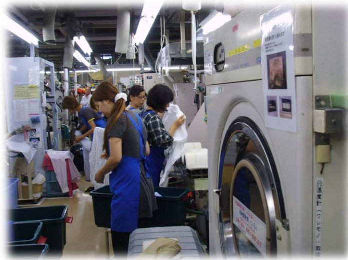
รูปที่ 18 สายการทำทำความสะอาดเสื้อผ้า ประกอบด้วย 3 สาย A,B,C และแต่ละสายจะมีการซักน้ำอุ่นและการซักแห้ง โดยนำเสื้อผ้าเข้าที่ละ 10 ชิ้น
