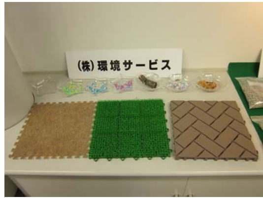
รูปที่ 11 เศษวัสดุก่อสร้างผ่านกระบวนการคัดแยกนำมาผลิตเป็นวัสดุปูพื้น
