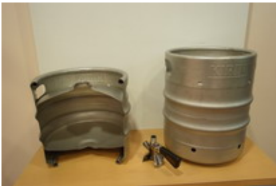
รูปที่ 19 การเปลี่ยนแปลงรูปทรงของถังเบียร์สดเพื่อลดปริมาณอะลูมิเนียม
