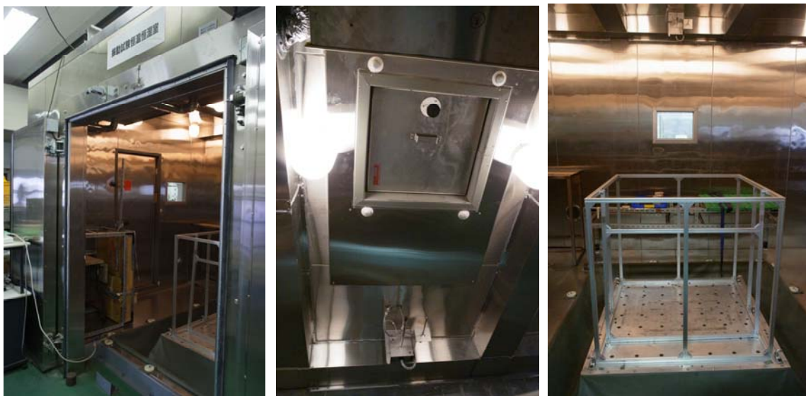
รูปที่ 21 เครื่องมือทดสอบผลกระทบที่เกิดขึ้นกับผักผลไม้ที่บรรจุในบรรจุภัณฑ์
