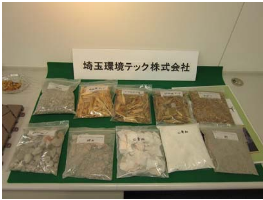
รูปที่ 11 เศษวัสดุก่อสร้างผ่านกระบวนการคัดแยกนำมาผลิตเป็นวัสดุปูพื้น
