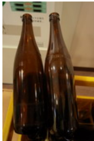
รูปที่ 16 การลดความหนาของขวดเพื่อลดปริมาณแก้ว
