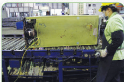
รูปที่ 11 การดูดเก็บสารทำความเย็น
