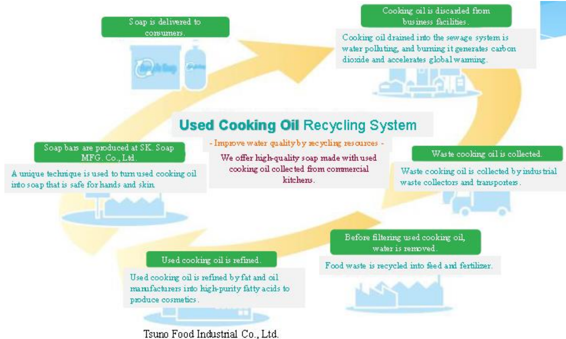
ภาพที่ 20 ขั้นตอนการนำน้ำมันพืชใช้แล้วมาทำการผลิตผลิตภัณฑ์สบู่
