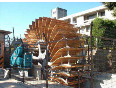
葛原配水池発電所 (リンクレスフランシス水車-直結方式)
