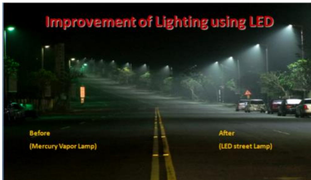
ภาพถ่ายเปรียบเทียบระหว่าง Mucury vapor lamp และ LED street lamp
