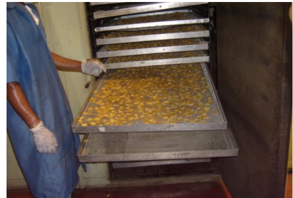
นำเข้าเครื่องอบแห้งอุณหภูมิประมาณ 65 C เป็นเวลา 10-12 ชม.
